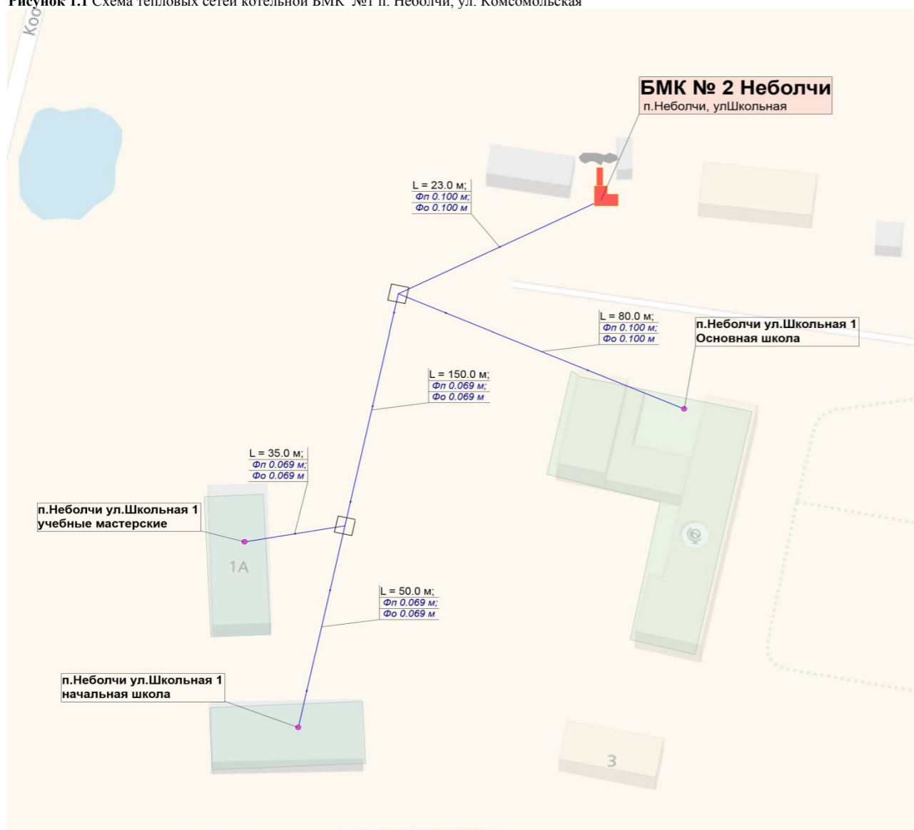
Рисунок 1.1 Схема тепловых сетей котельной БМК №1 п. Неболчи, ул. Комсомольская
