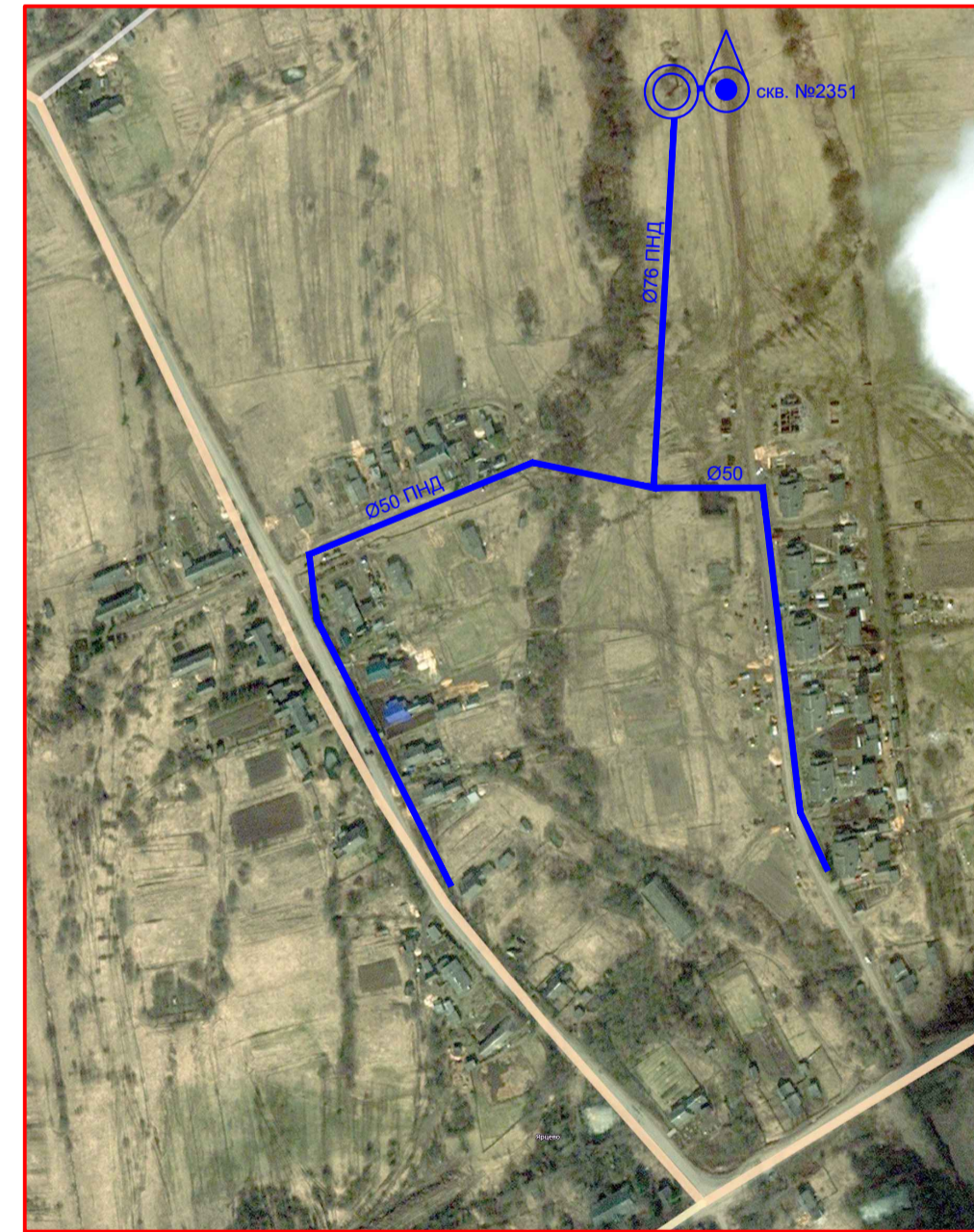
Схема водоснабжения д. Ярцево фрагмент территории
